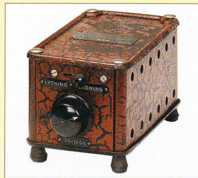
Obr. 4. První výrobek z r. 1925 byl „eliminátor“, síťový napáječ
