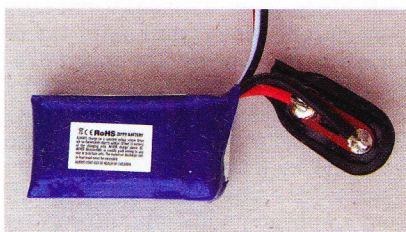
Obr. 1. Modelářský konektor jsem odštíhl (každý vývod zvlášť!) a připejál konektor z klipsu pro baterii 9 V
